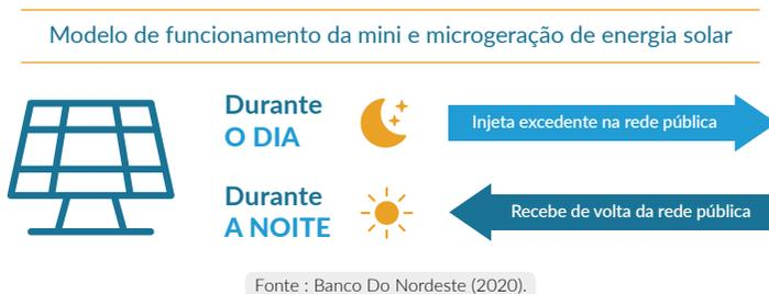
No caso, os sistemas a serem instalados são dimensionados de modo que o total gerado durante o mês seja compensado pelo total consumido no mesmo período. Se houver maior consumo do que geração, há a cobrança na conta de energia elétrica, e se houver maior geração do que consumo, o excedente de energia será cedido a título de empréstimo gratuito para a concessionária, passando a unidade consumidora a ter um crédito em quantidade de energia ativa a ser consumida por um prazo de 60 meses.
